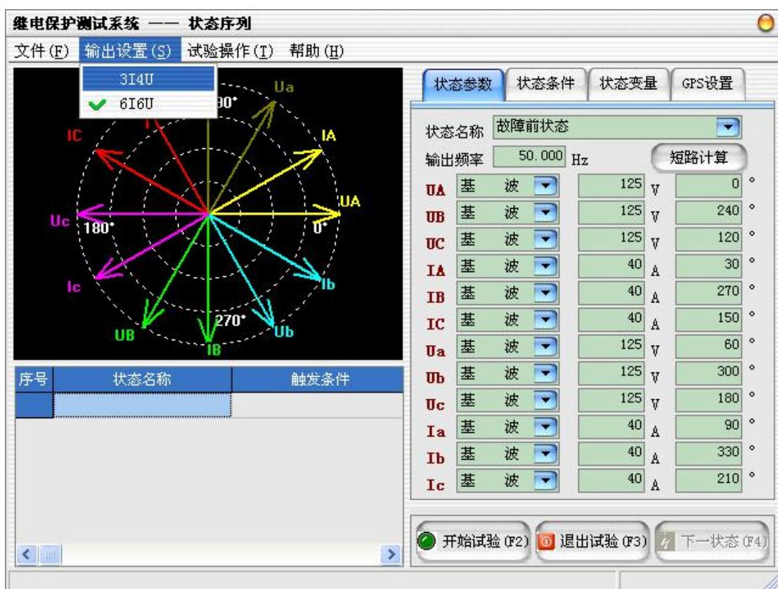
三相电流四相电压的测试仪只能使用“3I4U”的输出方式，六相电流六相电压的测试仪则既可使用“3I4U”的输出方式，也可使用“6I6U”的输出方式。
