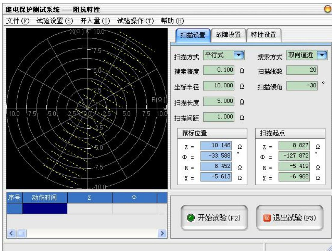
试验中待测试的扫描边界点由起点阻抗Z、扫描线倾角、间距以及扫描线数目决定，同理，此处扫描线倾角以平行于R轴为0°。设置完以上参数后，程序自动以起点阻抗Z为开始，沿R轴正方向，按“扫描间距”等距离地计算各扫描
