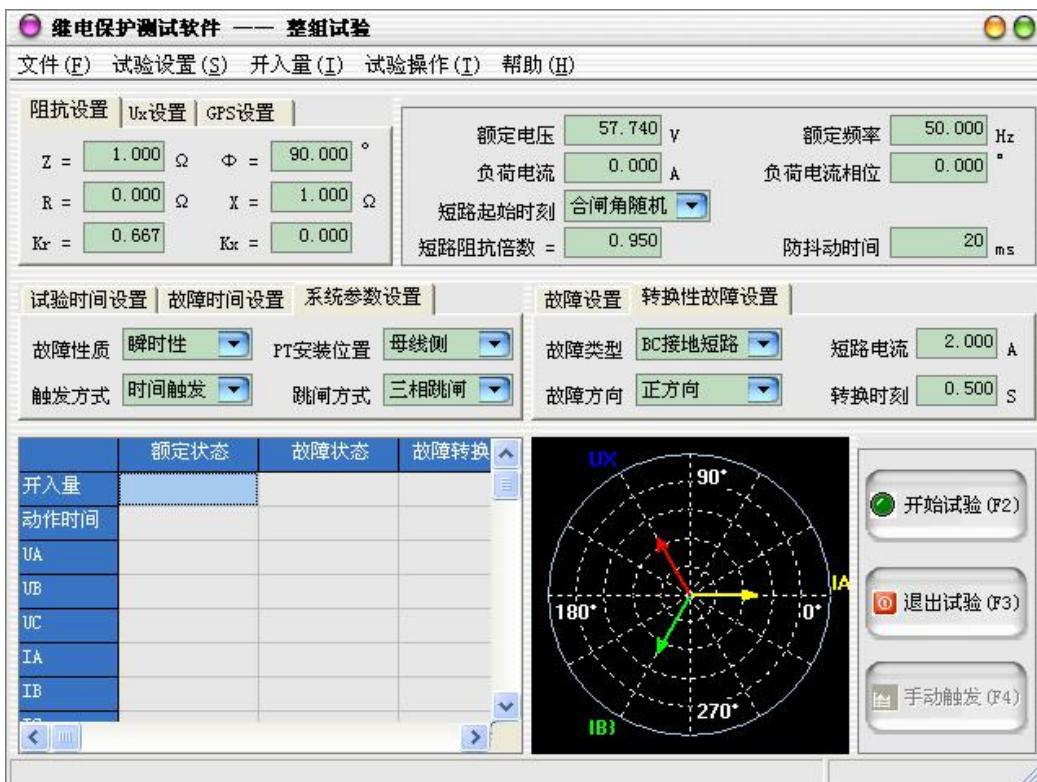
在将“故障设置”中的“转换性故障”选项打上了勾后，则可以进入“转换性故障设置”属性页中对转换性故障进行参数设置。
