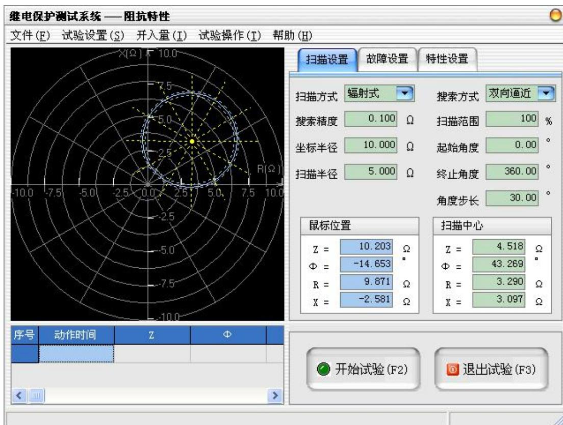
试验中待测试的扫描边界点由扫描角区域和步长决定，此处，扫描角度以平行于R轴为 $0^\circ$ 。例：取扫描角区域为 $0^\circ$ 到 $360^\circ$ ，步长为 $30^\circ$ ，则程序自动以 $0^\circ$ 为起点，以 $360^\circ$ 为终点，按逆时针方向，每隔 $30^\circ$ 计算一条扫描线。各扫描线的起点均为中心阻抗Z，长度
