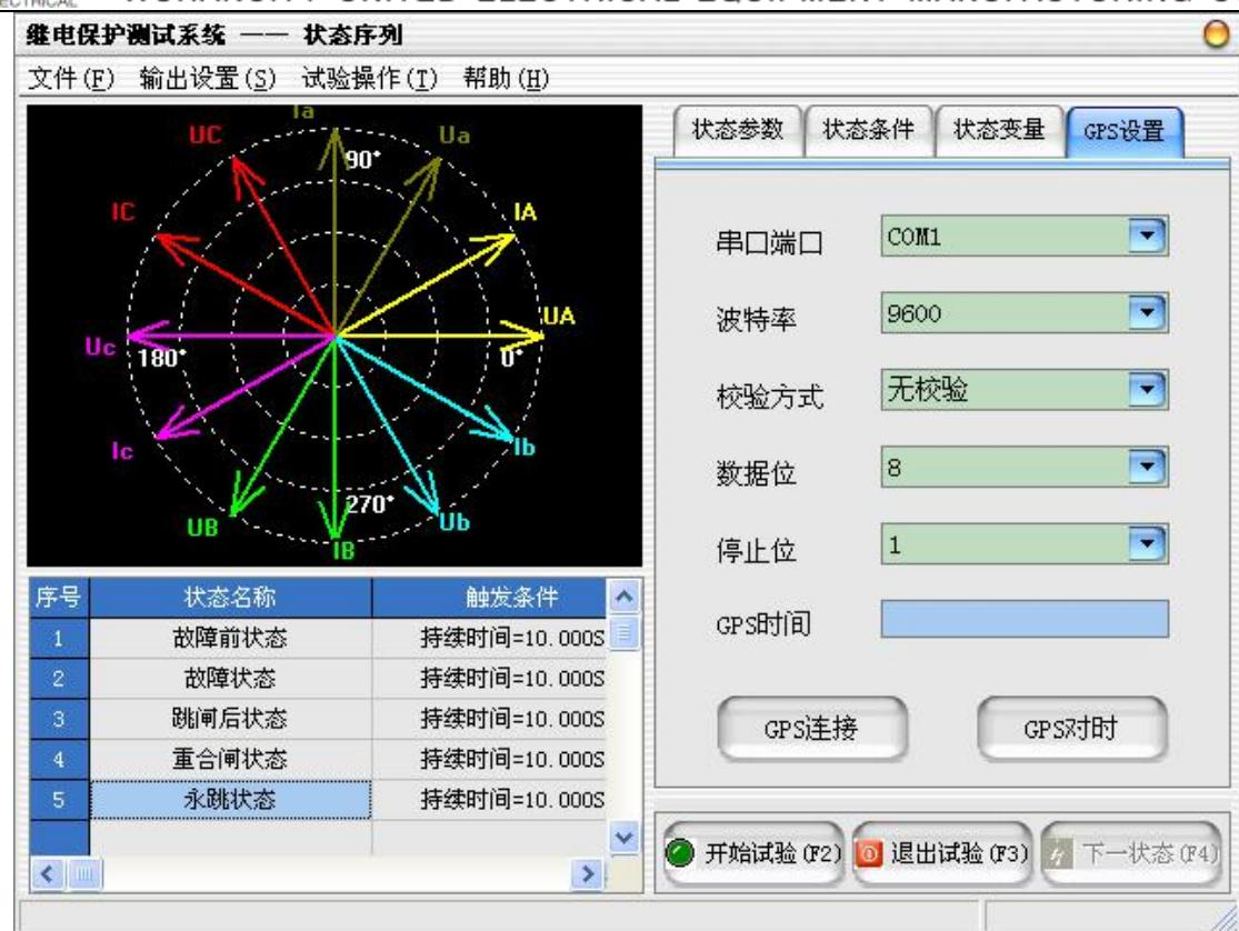
当选择“GPS触发”时，点击“开始试验”，测试仪并不会立即输出电压、电流，只有当下一分钟的0秒到时，测试仪才会开始输出下一状态的电压、电流，在该状态设置的“最长状态时间”到后，将进入下一状态。
