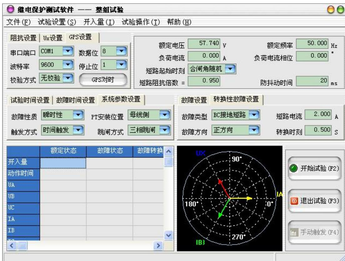
当“触发方式”选择了“GPS触发”时，可在界面左上角进行GPS参数设置。
