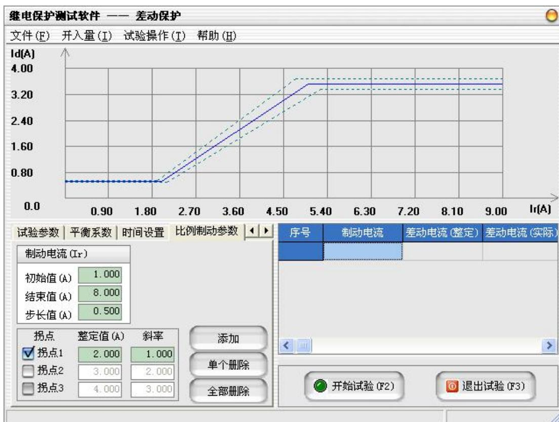
在“比例制动参数”属性页中设置比例制动特性的拐点和试验要测试的制动点。
